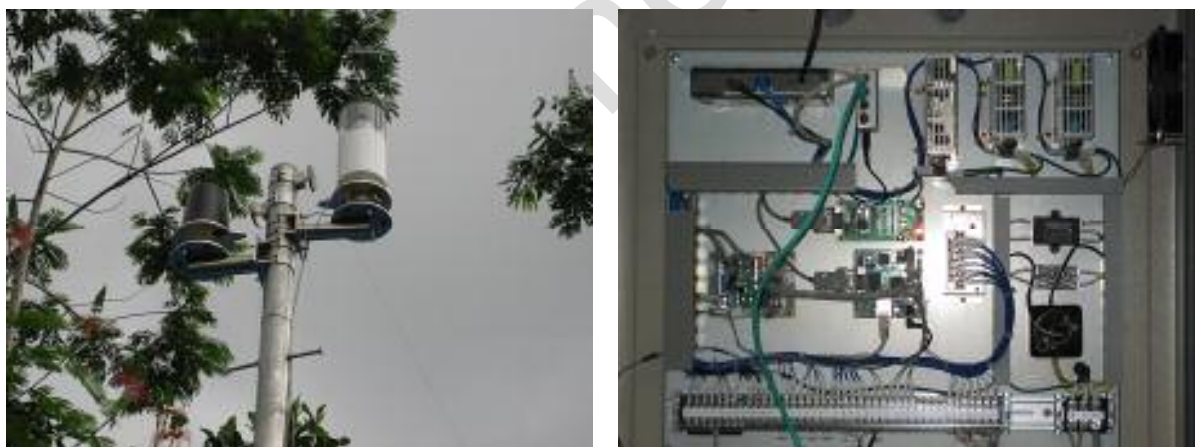
Hình 3. Điểm cố định có vũ lượng kế và máy ảnh mạng, và hộp ngoài trời có Máy đo trường và các mạch liên kết.
